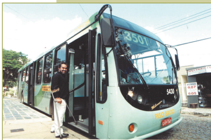
Foto 22 - Ônibus com piso baixo. Embarque ao nível da calçada complementado por rampa basculante do veículo. Campinas, 2006.
