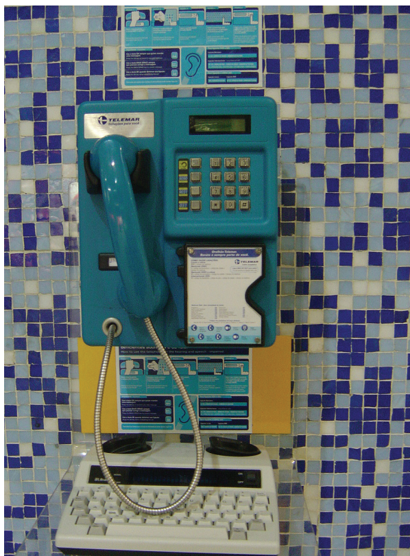
Fig. 12. Telefone público (TDD) que emite e recebe mensagens de texto permite a comunicação das pessoas com deficiência auditiva.
