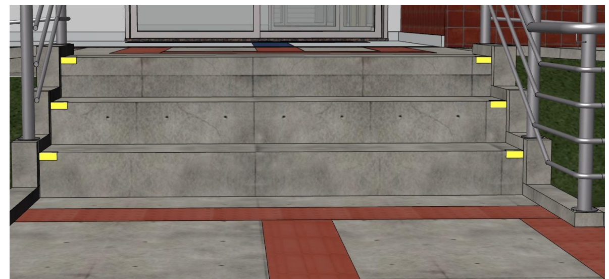
Perspectiva - Sinalização de escadas NBR 9050:2015
