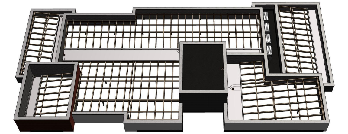
Perspectiva - Madeiramento telhado
