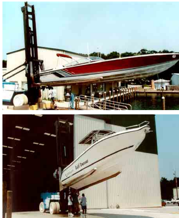
FIGURA 9: FORKLIFT NO TRANSPORTE DE BARCOS
