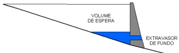
FIGURA 42 – ESQUEMA DE RESERVATÓRIO PARA CONTROLE DE CHEIAS
