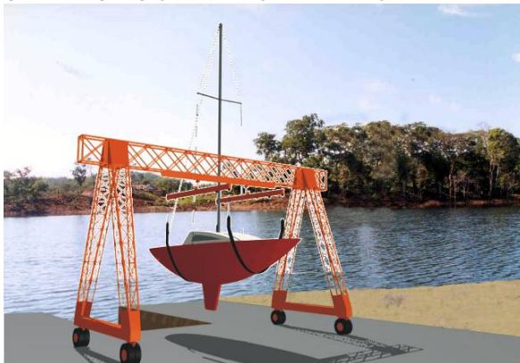
FIGURA 20 – IÇAMENTO DO BARCO, ATRAVÉS DE PÓRTICO, ATÉ A CARRETA QUE O LEVARÁ AO LOCAL DE ESTACIONAMENTO DEFINITIVO
